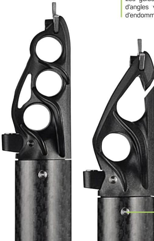
Les têtes sont en Nylon, elles sont montées sur le tube avec 2 joints toriques. L'assemblage sur le tube se fait par une goupille de diamètre 5mm.
