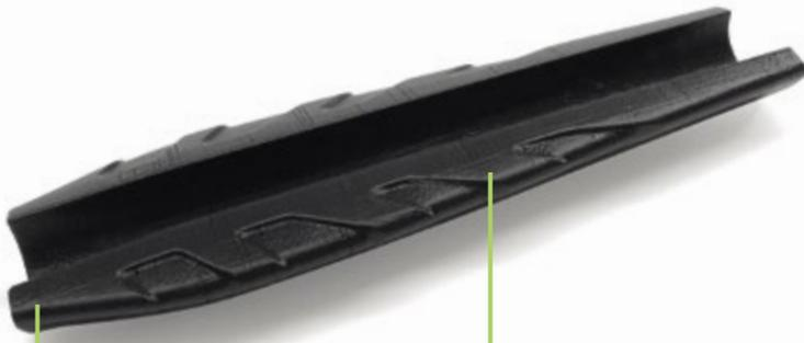
Les flotteurs sont en mousse de polyuréthane rigide, de densité 0.21g/cm<sup>3</sup>. Ils ont un profil en C, un diamètre de 30mm pour pouvoir être montés sur des tubes de diamètre 30mm.
